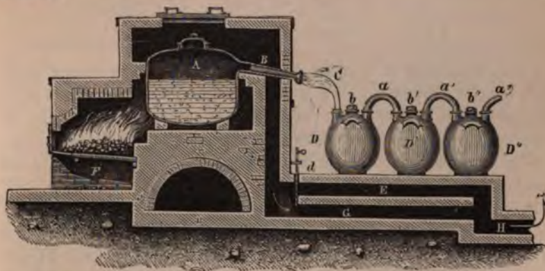
Fig. 126. — Appareil industriel pour la fabrication de l'acide azotique.
